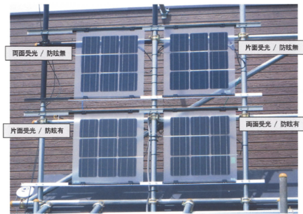
図 8 各タイプ BIPV モジュールの屋外計測 4)
