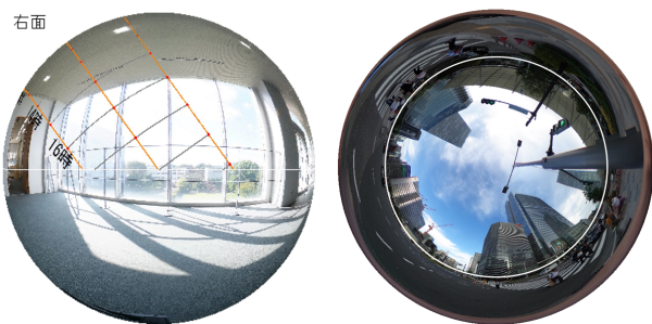
b) 立体角投影 c) 正積方位投影 図6 室内外放射環境の簡易評価手法
