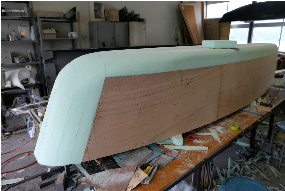
図4 端部をスタイロフォーム、面材を2.5mm合板で仕上げた捨て型枠
