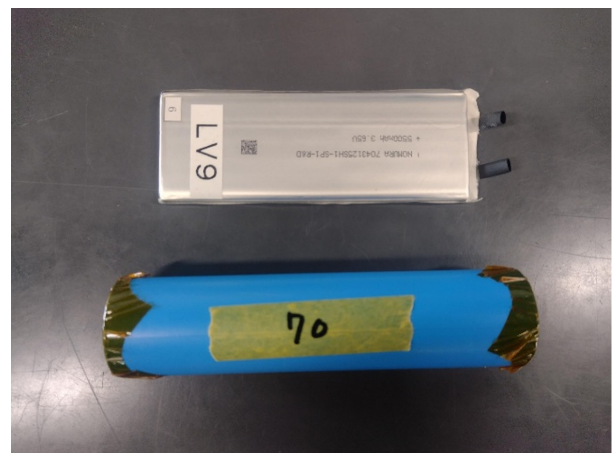
図10 ラミネート型リチウムイオンポリマー電池と円筒型リン酸鉄型リチウムイオン電池の外観。
