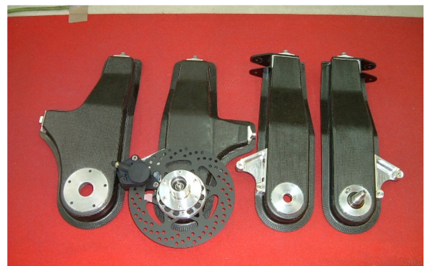
図7 カーボン・コンポジット製アップライト
