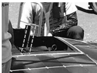
Fig. 10 Installation point of the external waterproof antenna hidden under the CFRP canopy (WGC). 図10 炭素繊維強化プラスチック製キャノピーの下に隠れた外付け防水アンテナの設置場所(WGC)
