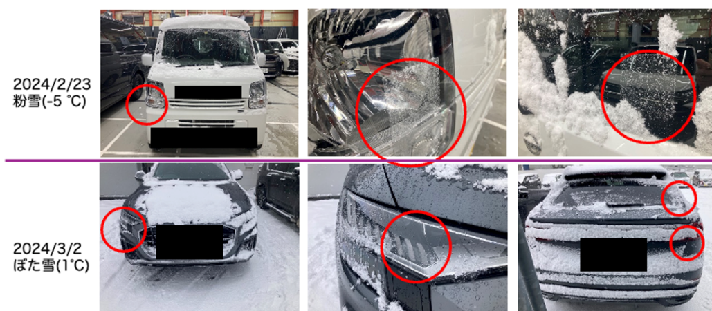
図 12 SLUG 実車貼付による滑雪性の評価
