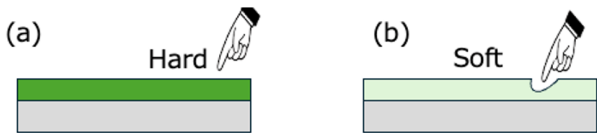
図5 機械的性質に注目した着雪制御材のイメージ。(a) 硬い表面、(b) 柔らかい表面。
