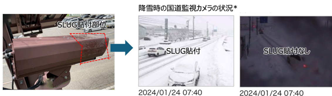
図 13 SLUG 道路監視カメラ貼付による滑雪性の評価
