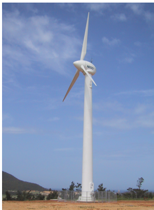
図7 富士重工業 100kW 風力発電機 (撮影・提供：足利大学 永尾 徹)
