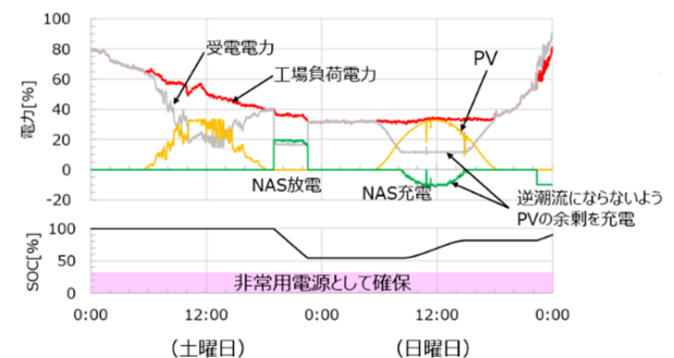
図 9 工場内太陽光発電の有効利用例
