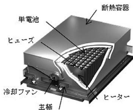
図3 モジュール電池の構成
