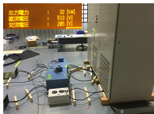
図 6 高周波伝導妨害波エミッション測定（代替）
