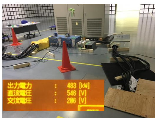
図 7 高周波伝導妨害波エミッション測定（代替）
