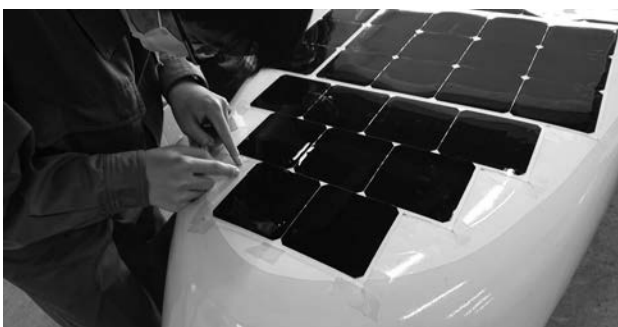
図20 車体前部、変則的な形状のモジュール
