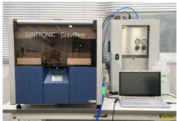
図3 透湿抵抗測定機（GraviTest 6400-50）
