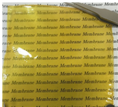
図6 溶液キャスト法によって得られたSPP-QP薄膜（膜厚は30マイクロメートル）
