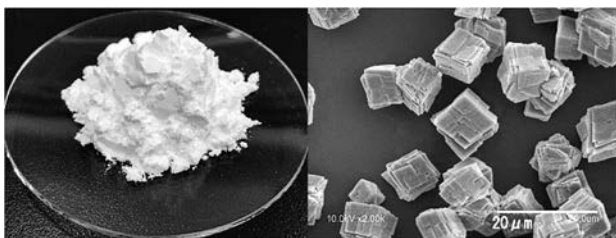
図 9 IDC 方式での人工石灰石外観と SEM 像の一例
