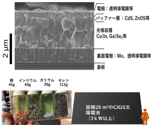
図7 (上) CIGS 太陽電池の断面 (SEM 観察像)
