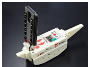
図4 原子炉建屋内格納容器機器ハッチの調査のために自社開発した「スマートフォンロボット」
