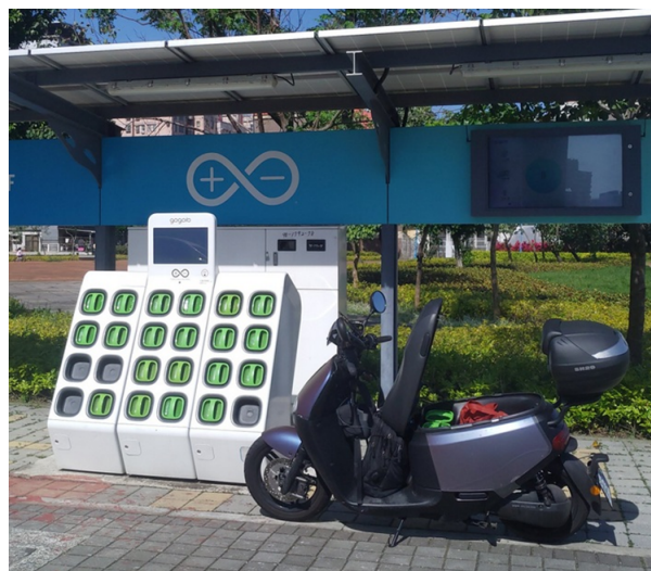
図8 バッテリー交換式EVスクーターと交換ステーション。 (CC BY-SA 4.0 Alexsh@Wikipedia)
