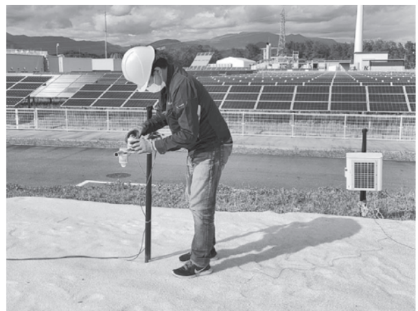
図4 屋外作業：太陽電池リサイクルガラスの反射率（アルベド）の計測準備をしているところ
