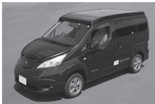
図3 NEDO による太陽光発電システム搭載自動車実証車両 (左: トヨタ自動車 プリウスプラグインハイブリッド (PV 容量 860W)<sup>4)</sup>, 右: 日産自動車 e-NV200 (PV 容量 1,150W)<sup>5)</sup>)
