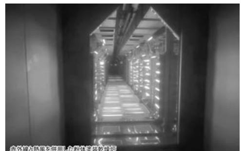
図8 赤外線と熱風を併用した乾燥炉
