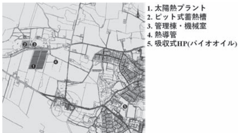
図7 Dronninglundの太陽熱地域熱供給の配置図(出典：文献11)
