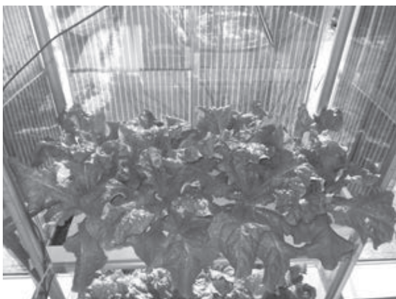
(a) 半透明有機薄膜太陽電池を用いた植物栽培実験
