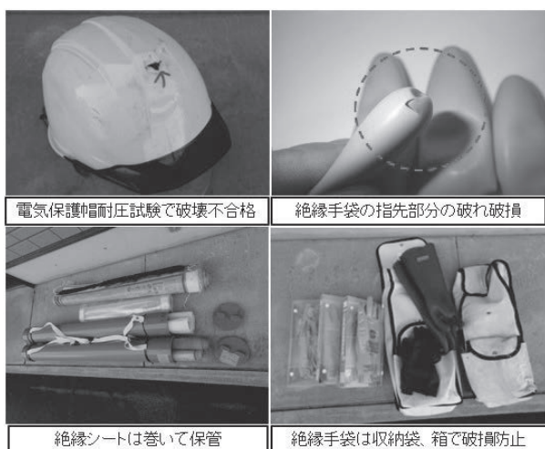
写真11 絶縁保護具の破損と保管
