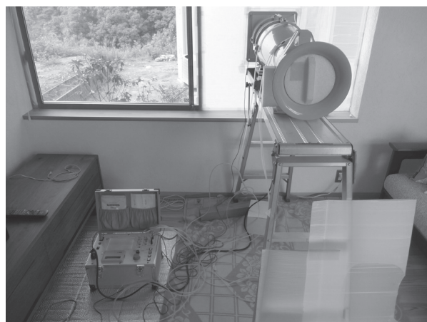
写真13 気密測定結果C値 = 1.56\text{cm}^2/\text{m}^2 (玄関木製建具を目張りすると 1.03\text{cm}^2/\text{m}^2 ) であった。
