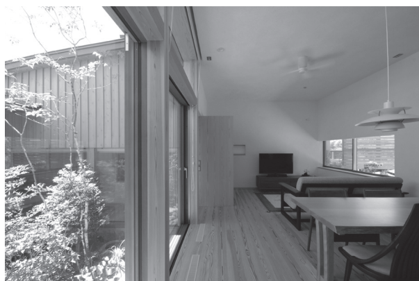
写真10 LDKの天井扇は廊下に風が流れる位置に取付け
