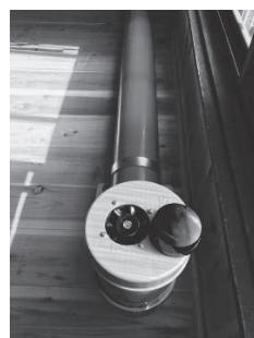
図22 全体、熱交換器、冷却用ファン
