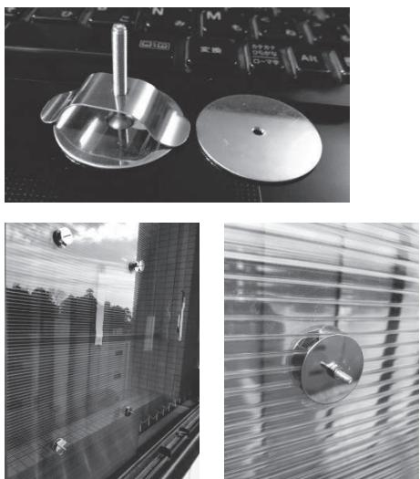
図23 特殊ボルトとガラス面取付、ポリカ取付柏市市役所での実証試験中
