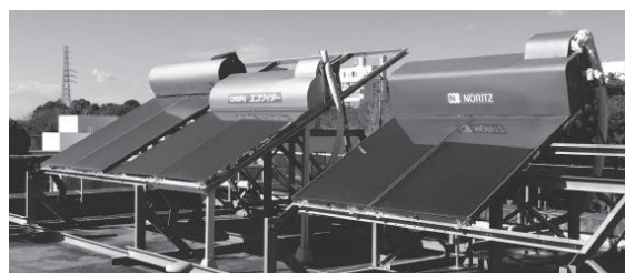
図6 フィールド試験中の太陽熱温水器三種
