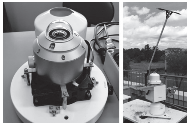
図8 開発した全天カメラ(左)と太陽追尾装置に搭載した様子(右)。
