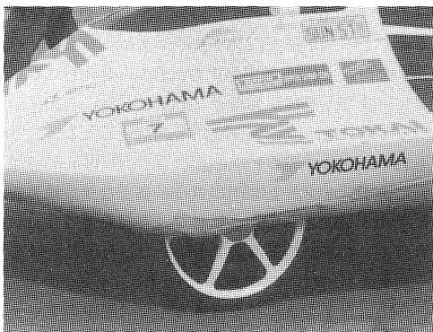
図 7 開発されたソーラーカー専用タイヤ
