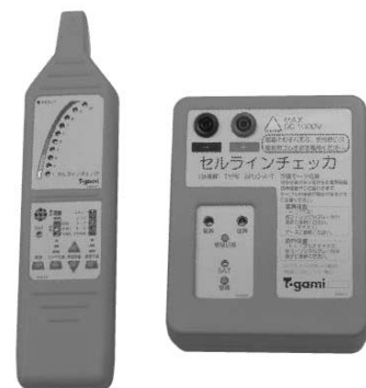
故障モジュール特定装置 ～セルラインチェッカ～ 特許5983039
