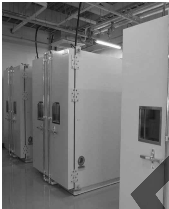
温度サイクル試験装置 (-40°C⇔85°C)
