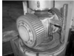
ローラー・ディスクダイ成形機でペレット状に加工
