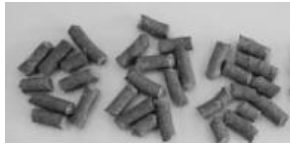
燃料ペレット(直径8mm) かさ密度は500kg/m 3 以上
