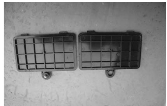
左側正常品、右側破損品
