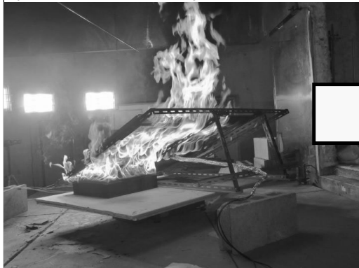
図 ヘプタンでのモジュール加熱状況
