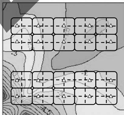
モジュール単体のまま、金具4点を用いて屋根材に固定
