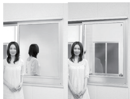
Fig. 2 Snapshots of prototype switchable mirror window during mirror/transparency transformation. 図2 プロトタイプの調光ミラーガラスの構造とスイッチングの様子 (9)
