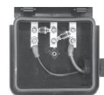
図 2 太陽電池モジュールの接続箱の例
